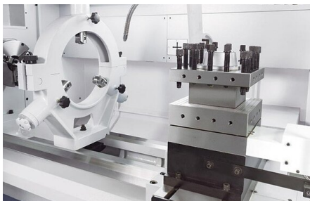
Support en acier servo-commandé à 4 emplacements, automatique et robuste, pour le changement d'outil programmé
