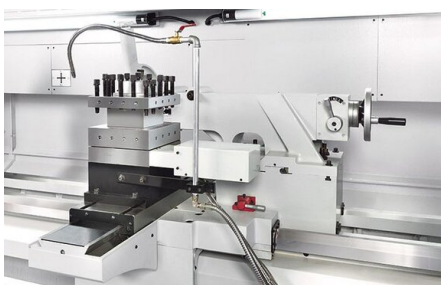
Manipulation aisée : pour le positionnement, il est possible d'accoupler la contre-poupée sur le support
